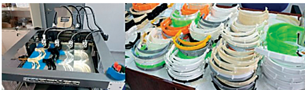
Ο βιομηχανικού τύπου εκτυπωτής της δράσης, με 4 ανεξάρτητες κεφαλές εκτύπωσης (αριστερά), και εκτυπωμένα μέρη των προμετωπίδων (δεξιά). Διαστάσεις φύλλου προμετωπίδας: 240mmx240mm, δυνατότητα παραγωγής: 400 ανά εβδομάδα ( http://3dpntuahub.gr/ )
