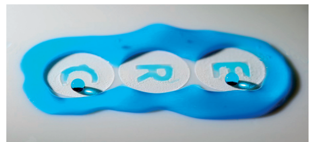
Εικόνα 7: Δυνατότητα της μεθόδου να «γράφει» νησίδες υδροφοβικότητας πάνω σε πολυμερικές επιφάνειες. Εδώ παρουσιάζεται το λογότυπο του Ευρωπαϊκού Συμβουλίου Έρευνας (ERC) σε επιφάνεια PFTE (Teflon).
