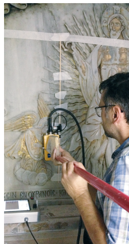
Διασκόπηση με γεωραντάρ του αναγλύφου της Ανάστασης του Χριστού στο εσωτερικό του Ταφικού Θαλάμου
