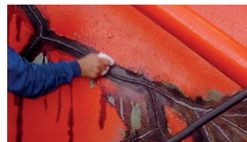
Σχήμα 9. Ψαθυρή θραύση κατασκευαστικού στοιχείου πλοίου μετά από έκθεση σε κρυογονικές θερμοκρασίες.
