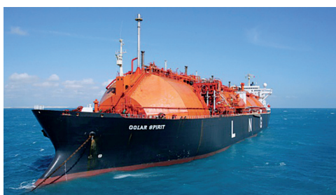
Σχήμα 5. Το χωρητικότητας 129.000 κυβικών μέτρων FSRU, Golar Spirit (Πηγή: Petrobras)
