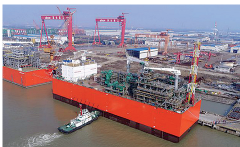
Σχήμα 6. Το χωρητικότητας 25.000 κυβικών μέτρων FSRU-φορτηγίδα της Exmar (Πηγή: Wison Offshore & Marine)
