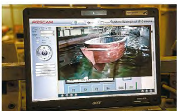
Αισθητήρες και κάμερες καταγράφουν σε πραγματικό χρόνο τη συμπεριφορά του «Αρν» κατά την πλεύση.
