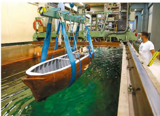
Το σκαρί του «Αρν» εισάγεται στη δεξαμενή και προσδέεται στον μηχανισμό ρυμουλκίωσης.
