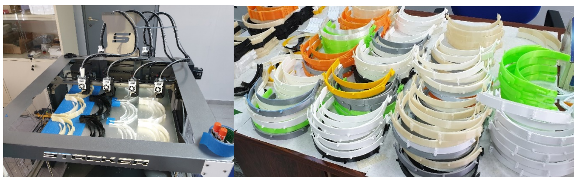
Εικόνα 1. Ο βιομηχανικού τύπου εκτυπωτής της δράσης, με 4 ανεξάρτητες κεφαλές εκτύπωσης (αριστερά), και εκτυπωμένα μέρη των προμετωπίδων (δεξιά). Διαστάσεις φύλλου προμετωπίδας: 240mmx240mm, δυνατότητα παραγωγής: 250 ανά εβδομάδα [3DP-NTUA hub]
