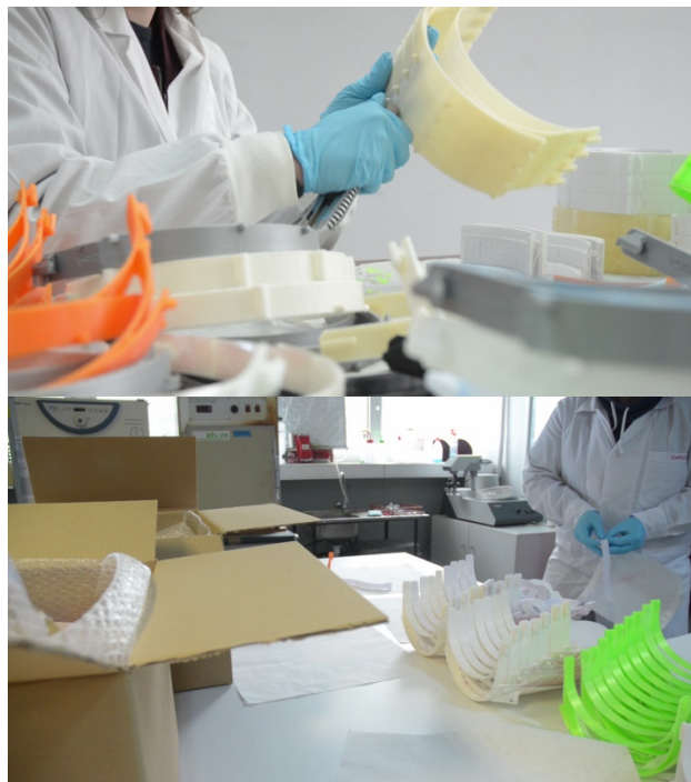
Εικόνα 7. Επεξεργασία μετά την εκτύπωση (φινίρισμα) και επιλογή προς συναρμολόγηση [3DP-NTUA hub]
