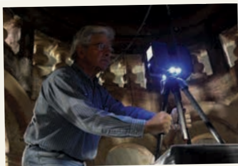
Καθ. ΕΜΠ. Ανδρέας Γεωργόπουλος: Γεωμετρική τεκμηρίωση με σάρωση laser του εσωτερικού θόλου του Τρούλου του Ιερού Κουβουκλίου
